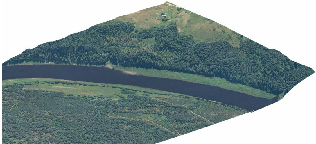
2.5.1.6. attēls. Dabas pieminekļa “Daugavas vārti” Veru kraujas digitāli ģenerēts zemes virsmas modelis, skats no ZR. Modelis iegūts ortofoto karti uzklājot uz digitālā reljefa modeļa. (ortofotokarte lapas Nr 2444-51. 2005. © Latvijas Ģeotelpiskās informācijas aģentūra).
