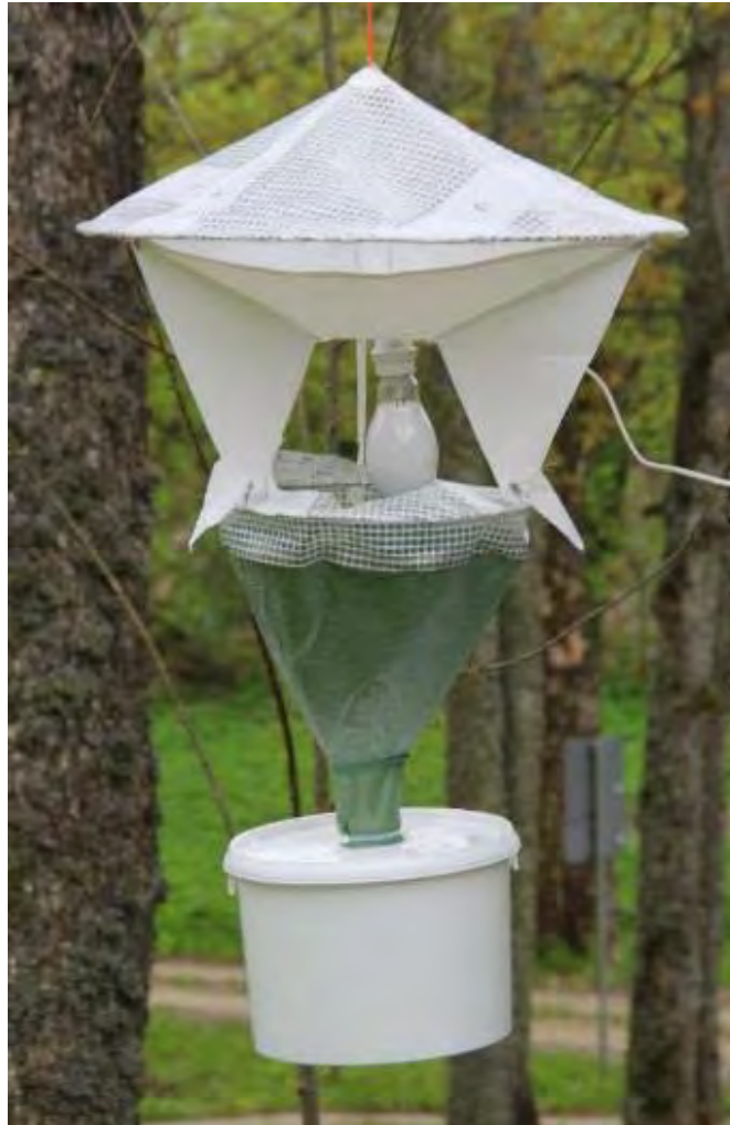
3.1.2. attēls. Naktstauriņu lamatas (gaismas pašķērājiekārta).
