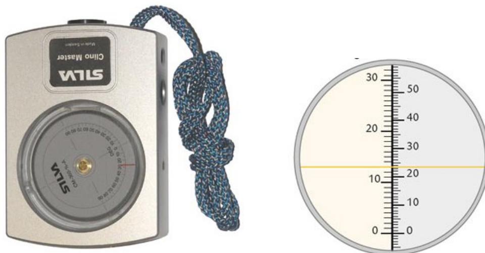
12. attēls. Klinometrs rāda leņķi no horizonta un aviouzskaitēs tiek izmantots, lai noteiktu attāluma joslu robežas.
