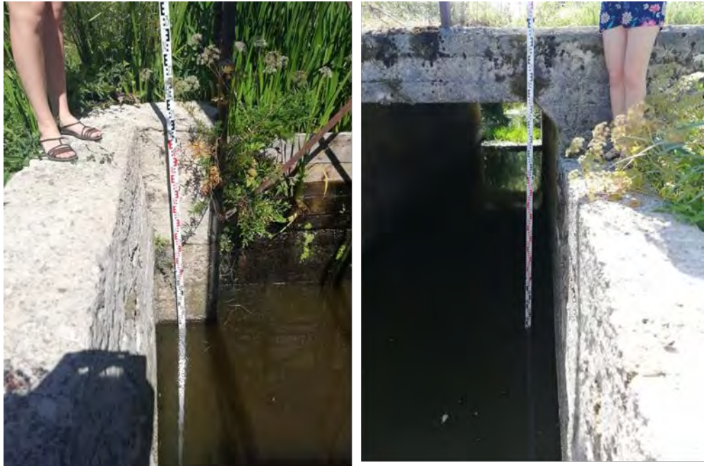
19. attēls. Ūdens līmeņa uzmērīšana ar latu caurtekā – regulatorā (Avots: no personīgā arhīva, 25.07.2019.)
