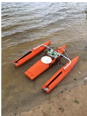
20. attēls. Mērījumiem izmantotais hidroakustiskais straumes mērītājs RiverRay (Avots: no personīgā arhīva)
