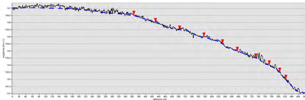
5.2.1.3. attēls. Provizorisks aizsprostu kaskādes izvietojums uz Raktupītes, atjaunojot hidroloģisko režīmu susināšanas ietekmētajās teritorijās. Melnā līnija – augstā purva kūdras kupola virsmas šķēršprofils; zilā pārtrauktā līnija – Raktupītes gultnes profils; sarkanie trijstūri – ieteicamās aizsprostu izbūves vietas.
