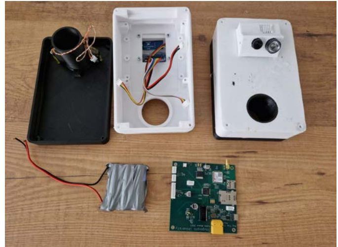
1.2.2.4. attēls. LVAF projekta ietvaros uzlaboto viedo lamatu galvenās komplektējošās komponentes (Foto: U. Valainis)
