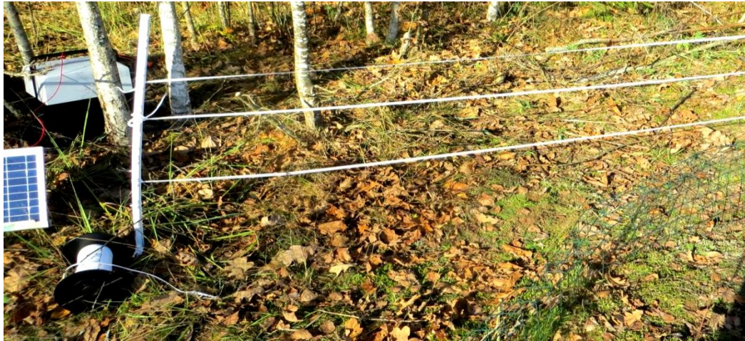
32.att. Aploka elektriskā gana daļa ar elektrisko ganu Ranger A3000 un saules bateriju.
