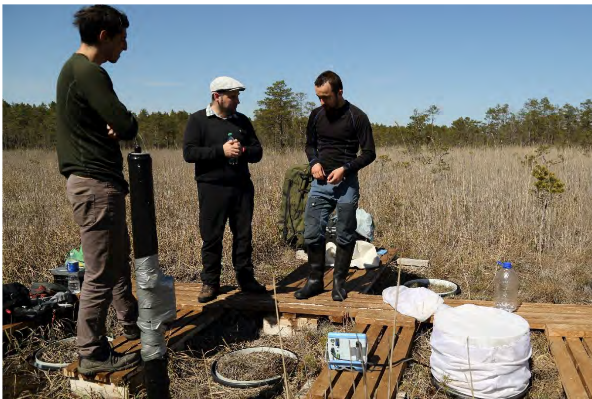
1. attēls. Mērījumi ar necaurspīdīgo kameru LIFE “Peat Restore” projektā Engures ezera dabas parka kaļķainajos zāļu purvos. Foto: M. Pakalne.
