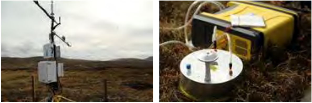
6. attēls. Eddi kovariances iekārta Skotijas augstkalnēs. Foto: M. Pakalne.
