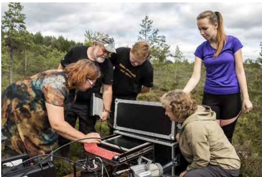
3. attēls. Siltumnīcefekta gāzu mērījumi ar Picarro G2508 iekārtu Madiešēnu purvā Augstrozes dabas liegumā. Foto: D. Beķere
