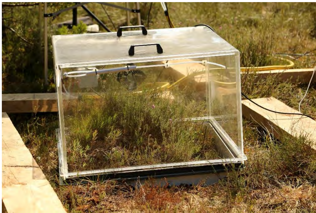
2. attēls. Causpīdīga kamera, ar kuru tiek veikti siltumnīcefekta gāzu mērījumi LIFE “Peat Restore” projekta vietās Vācijā un Polijā. Foto: M. Pakalne
