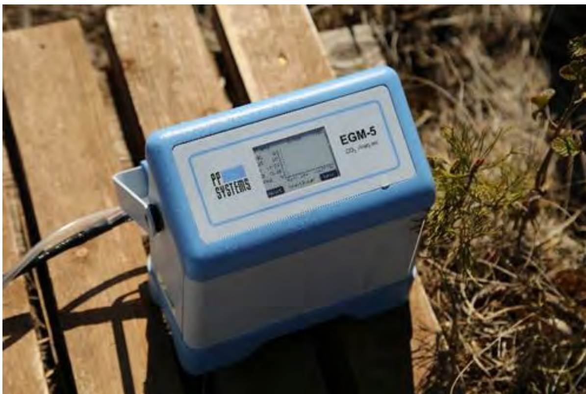
4. attēls. Iekārta EGM-5 CO 2 noteikšanai lauka apstākļos. Foto: M. Pakalne
