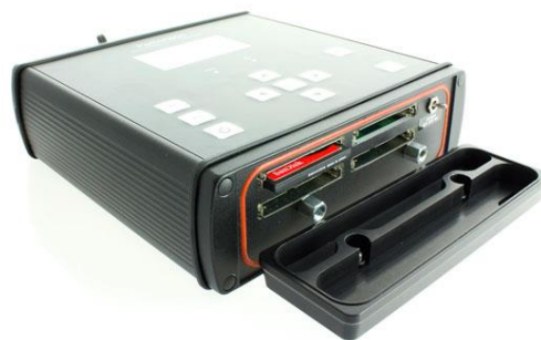
3. att. Pettersson Elektronik D-500X ultraskaņas detektors. Pa kreisi – virsskats, pa labi – atvere atmiņas karšu ievietošanai [5].
