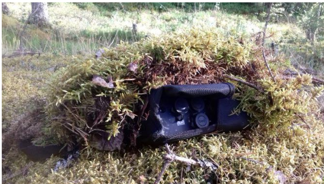
3. attēls Ultraskaņas detektors Pettersson Elektronik 500-x uzstādīts uz zemes un nomaskēts automātiskai sikspārņu reģistrēšanai skujkoku mežā.
