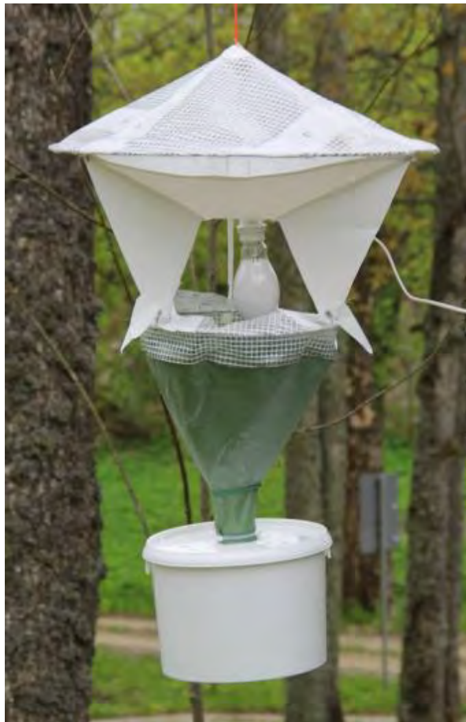
3.1.2. attēls. Naktstauriņu lamatas (gaismas pašķērājiekārta).
