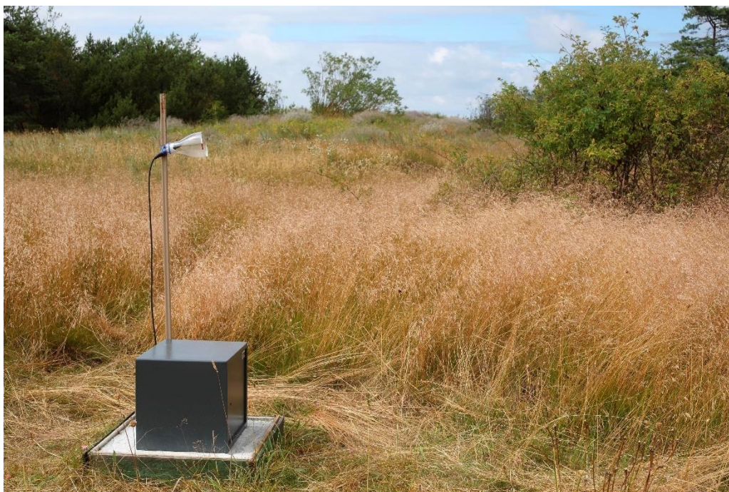
3.1. attēls Automātiskais detektors D-500 novietots metāla seifā. Detektoram pievienots ārējais mikrofons, kuru no lietus aizsargā plastmasas konuss.
