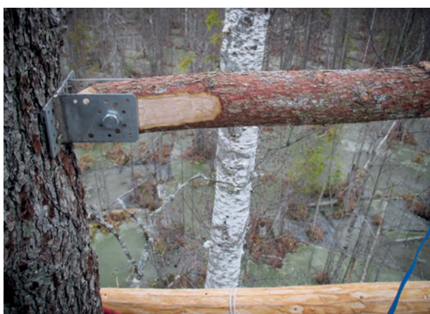
3. attēls. „Krāna” kronšteins piestiprināts virs paredzētās balsta nostiprināšanas vietas. Foto: J. Ķuze. Figure 3. Attachment point of supporting device, used during the lifting and positioning of nest supports. Photo: J. Ķuze.
