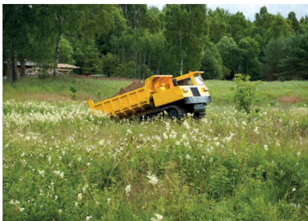
4. attēls. No akmeņu un grants pievešanas vietas līdz upei materiāls tika nogādāts ar tehniku, kura ir aprīkota ar kāpurķēžu sistēmu. Foto: H. Hofmanis. Figure 4. The boulders and gravel were transported to the river by vehicles equipped with tracks. Photo: H. Hofmanis.
